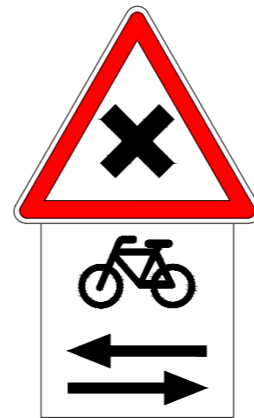
59. ábra: Egyenrangú útkeresztezések esetén kihelyezendő jelzésekép
