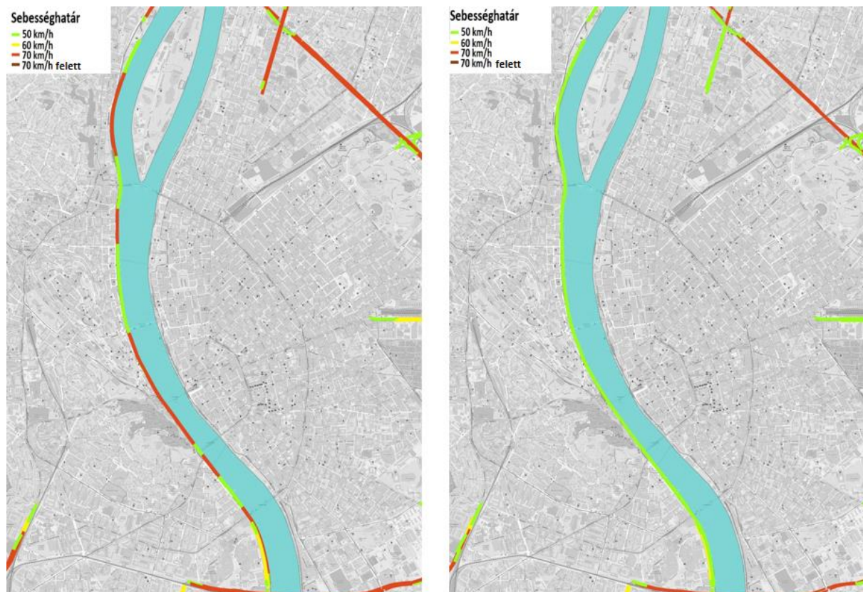
29. ábra A meglévő és javasolt legnagyobb sebesség meghatározása a budai alsó rakparton. Forrás: Saját szerkesztés, BKK
